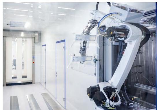
Die im Spritzguss gefertigten Teile werden von Robotern dem Etagenwerkzeug entnommen, von einer Kamera geprüft und dann gestapelt.
