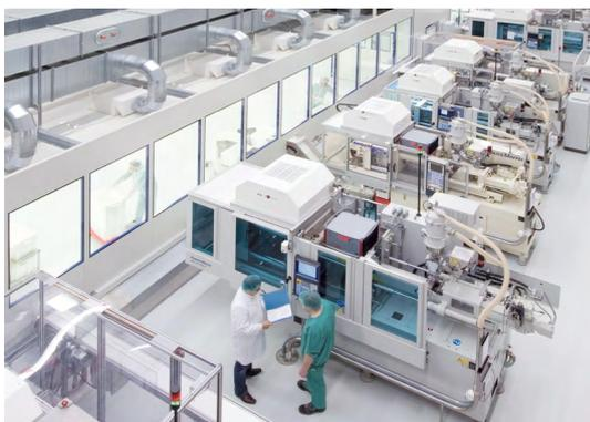
Durch die Aufstellung der Maschinen außerhalb des Reinraums halten wir den Energieeintrag pro Quadratmeter Produktionsfläche so gering wie möglich.
