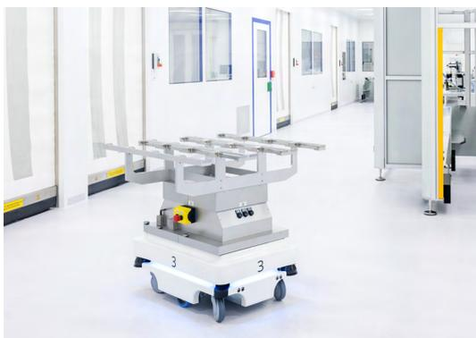
Fahrerlose Transportsysteme (FTS) übernehmen autonom und sicher den Transport und die Übergabe an die Verpackungsmaschine.
