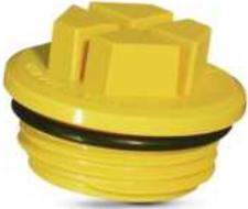
Die Dichtstopfen mit O-Ring GPN 738 sind passend für das Verschließen von Einschraublöchern nach DIN 3852-1 und ISO 11926 und besonders geeignet für erhöhte Dichtigkeitsanforderungen. Das robuste Material ist hochwertig und besonders schlagzäh. Die umlaufende Dichtlippe, die ohne Formtrennprat ausgeführt ist, und der O-Ring verhindern innerhalb gewisser Grenzen das Eindringen und Austreten von Flüssigkeiten. Die Montage erfolgt durch Schraubendreher oder Schraubenschlüssel.
