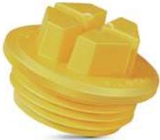
Die Dichtstopfen GPN 735 sind passend für das Verschließen von Einschraubblöchern nach DIN 3852-1 und DIN ISO 6149-1 und sind besonders geeignet für Prozesse wie Reinigen, Prüfen, Lackieren oder auf dem Transport. Das robuste Material ist hochwertig und besonders schlagzäh. Die umlaufende Dichtlippe, die ohne Formtrenngrat ausgeführt ist, verhindert innerhalb gewisser Grenzen das Eindringen und Austreten von Flüssigkeiten. Die Montage erfolgt durch Schraubendreher oder Schraubschlüssel.
