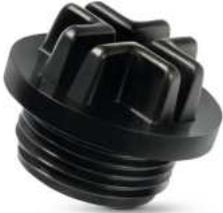
Die Dichtschrauben GPN 730 sind passend für eine Vielzahl metrischer Gewinde nach DIN 13 und Rohrgewinde nach DIN EN ISO 228-1. Das robuste Material eignet sich für eine erhöhte Beanspruchung. Die umlaufende Dichtlippe, die ohne Formtrenngrat ausgeführt ist, verhindert innerhalb gewisser Grenzen das Eindringen oder Austreten von Flüssigkeiten. Die Montage erfolgt durch Schraubendreher oder maschinell mit einem Spezialschlüssel.
