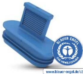
Der Kontaktschutz GPN 360 Form B dient dem Schutz von Kompaktstecker-Anschlüssen im Niedersvolt-Bereich wie MLK, SLK und MAK und ist ebenfalls geeignet für ovale Öffnungen. Die handliche Griffflasche garantiert eine schnelle Demontage und die umlaufenden Lamellen ermöglichen einen optimalen Klemmsitz. Innerhalb gewisser Grenzen verhindert der Kontaktschutz den Eintritt von Flüssigkeiten.
