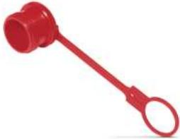
Die Staubschutzstopfen GPN 930 Form A schützen geöffnete Steckkupplungen, besonders das Gewinde, vor Beschädigung und Verschmutzung und besitzen eine Lasche aus PE-LLD als Verliersicherung. Die Staubschutzkappen besitzen ein Gewinde und verhindern innerhalb gewisser Grenzen das Eindringen oder Austreten von Flüssigkeiten.
