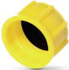
Die Schraubkappen mit Dichtscheibe GPN 802 sind passend für eine Vielzahl von Gewindearten, wie metrische Gewinde, Rohrgewinde und amerikanische Gewinde. Die Schraubkappe ist mit einer Dichtscheibe aus Nitril-Butadien-Kautschuk (NBR) ausgestattet, die erhöhten Dichtigkeitsanforderungen gerecht wird. Griffige Außenränder eignen sich für eine einfache Montage per Hand.
