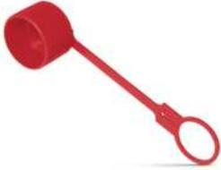
Die Staubschutzkappen GPN 930 Form B schützen geöffnete Steckkupplungen, besonders das Gewinde, vor Beschädigung und Verschmutzung und sind unverlierbar durch eine Lasche aus PE-LLD. Die Staubschutzkappen verhindern innerhalb gewisser Grenzen das Eindringen oder Austreten von Flüssigkeiten.
