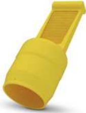
Die Leitungsendkappen GPN 212 sind insbesondere zum Schutz von Leitungen und Kugelbuchsen geeignet. Die ergonomisch geformte Griffflasche erleichtert die Handhabung bei Montage und Demontage. Das flexible Material ermöglicht den Einsatz für unterschiedliche Gegenstückgeometrien und ist kurzzeitig hitzebeständig bis zu 150° C.
