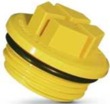
Die Dichtstopfen mit O-Ring GPN 737 sind passend für das Verschließen von Einschraublöchern nach DIN 3852-1 und DIN ISO 6149-1 und besonders geeignet für erhöhte Dichtigkeitsanforderungen. Das robuste Material ist hochwertig und besonders schlagzäh. Die umlaufende Dichtlippe, die ohne Formtrennprat ausgeführt ist, und der O-Ring verhindern innerhalb gewisser Grenzen das Eindringen und Austreten von Flüssigkeiten. Die Montage erfolgt durch Schraubendreher oder Schraubenschlüssel.
