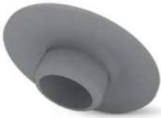
Die Abdeckungen GPN 340 eignen sich zum Schutz vor Verschmutzung und Beschädigung von versenkt angeordneten Schrauben mit Innensechskant nach DIN EN ISO 4762 und Verschlusschrauben nach DIN 908.
