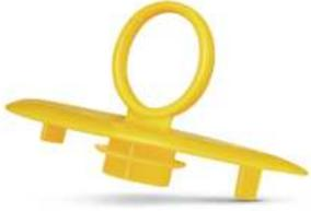
Die Flanschabdeckungen GPN 640 schützen SAE-Flansche vor Beschädigung und Verschmutzung und halten zuverlässig durch Klemmlamellen und Positionsstege. Die Ringlasche ermöglicht ein einfaches Handling und die Lamellen überbrücken größere Toleranzen.
