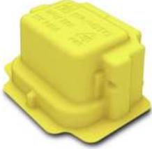
Der HV-Schutz GPN 380 Form D eignet sich zur Anwendung in Bauteilen und Komponenten der Klasse 5 in batteriebetriebenen Hybrid- und Plug-in-Hybrid-Fahrzeugen. Er schützt Stecker der Serie AMP+ HV 2100 von TE vor Korrosion und mechanischer Beschädigung. Zum Beispiel im Bereich des Eingangs zur Batterie, vom Onboard-Ladegerät zur Batterie, von der Batterie zum Wandler oder vom Wandler zum E-Motor.
