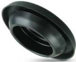
Die Dichtstopfen GPN 915 schützen Gehäuseöffnungen vor Verschmutzung und Beschädigung, sind einsetzbar für verschiedene Wandstärken und Öffnungsdurchmesser und haben eine sehr flache, bauraumsparende Ausführung. Dichtlippen verhindern innerhalb gewisser Grenzen das Eintreten von Flüssigkeiten. Das Material ist kurzzeitig hitzebeständig bis zu 180° C.
