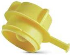
Die Griffverschlüsse GPN 335 dienen dem Schutz von Schlaucharmaturen nach DIN ISO 12151 beim Transport und bei der Lagerung. Die seitliche Griffflasche ermöglicht eine schnelle Demontage und flexible Lamellen dienen zur Überbrückung größerer Toleranzen. Der dünnwandige Kegel verhindert den Ein- und Austritt von Flüssigkeiten innerhalb gewisser Grenzen.
