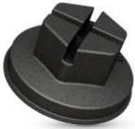
Die Lackierkappen GPN 734 eignen sich als Lackerschutz für die Dichtstopfen GPN 736 und GPN 738. Die Lackierkappen halten einen definierten Bereich um den Schraubstopfen lackfrei, erhalten die Optik der Dichtstopfen und Verringern die Gefahr der Kontaminierung der zu schützenden Öffnung.
