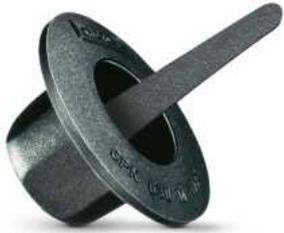
Die Griffstopfen GPN 630 eignen sich zum Schutz von Bohrungen und Innengewinden und sind kurzzeitig hitzebeständig bis zu 150° C. Die Anordnung der Lasche und das spezielle Design erlauben auch in scharfkantigen Gegenständen eine Demontage mit sehr geringem Materialabrieb. Die Abziehlasche ermöglicht eine schnelle Demontage.
