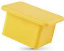
Der HDSCS Schutz GPN 365 ist geeignet zum Schutz der Heavy Duty Sealed Connector Series und schützt Stiftgehäuse und Kontaktstifte mit Polzahlen zwischen 2 und 18. Innenliegende Stege klemmen in der Innenkontur und der Stecker wird außen geschützt. Das Material ist kurzzeitig hitzebeständig bis zu 150° C.
