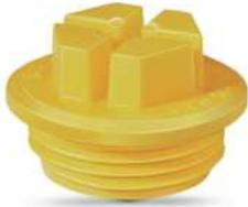
Die Dichtstopfen GPN 736 sind passend für das Verschließen von Einschraubblöchern nach DIN 3852-1 und ISO 11926 und sind besonders geeignet für Prozesse wie Reinigen, Prüfen, Lackieren oder auf dem Transport. Das robuste Material ist hochwertig und besonders schlagzäh. Die umlaufende Dichtlippe verhindert innerhalb gewisser Grenzen das Eindringen und Austreten von Flüssigkeiten. Die Montage erfolgt durch Schraubendreher oder Schraubenschlüssel.
