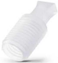
Les bouchons à languette GPN 607 conviennent pour protéger les perçages et les filetages internes, ils sont idéaux pour les travaux de peinture et résistent pendant de courtes périodes à des températures allant jusqu'à 250 °C. La languette garantit un démontage rapide tandis que les bourrelets périphériques empêchent la pénétration de liquides dans certaines limites. Grâce à leur forme conique, les bouchons permettent de surmonter des tolérances plus importantes.
