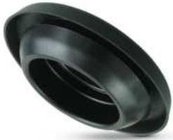
Les bouchons d'étanchéité GPN 915 protègent les ouvertures des boîtiers contre la saleté et les dommages. Ils peuvent être utilisés pour différentes épaisseurs de paroi et différents diamètres d'ouverture, ont un design très plat et sont peu encombrants. Les lèvres d'étanchéité empêchent la pénétration de liquides dans certaines limites. Le matériau résiste à la chaleur jusqu'à 180°C pendant de courtes périodes.
