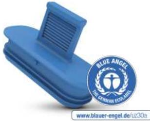
Le protecteur de connecteurs GPN 360 version A sert à protéger les raccords des connecteurs compacts en basse tension tels que MLK, SLK et MAK. Il convient également aux ouvertures ovales. La languette assure un démontage rapide et les lamelles périphériques permettent un serrage optimal. Dans certaines limites, la protection des contacts empêche l'entrée de liquides.
