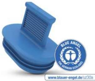
Les protecteurs de connecteurs MQS GPN 363 servent à protéger les connecteurs plats MQS de basse tension. La languette garantit un démontage rapide et les lamelles périphériques permettent un ajustement optimal du serrage. Le protecteur de connecteurs MQS offre une protection contre les projections d'eau IPX4 en fonction de la conception et de la qualité spécifiques du connecteur.
