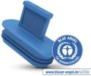
Le protecteur de connecteurs GPN 360 version B sert à protéger les raccords des connecteurs compacts en basse tension tels que MLK, SLK et MAK. Il convient également aux ouvertures ovales. La languette garantit un démontage rapide et les lamelles périphériques permettent un serrage optimal. Dans certaines limites, la protection des contacts empêche l'entrée de liquides.
