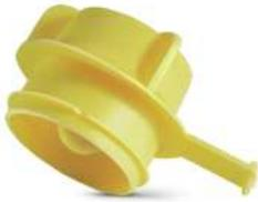
Les GPN 335 servent à protéger les raccords de tuyaux selon DIN ISO 12151 pendant le transport et le stockage. La languette latérale permet un démontage rapide et les lamelles souples servent à compenser les écarts de tolérance importants. Le cône à paroi mince empêche l'entrée et la sortie de liquides dans certaines limites.
