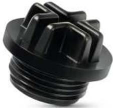
Les bouchons filetés GPN 730 conviennent à un grand nombre de filetages métriques selon DIN 13 et de filetages de tuyaux selon DIN EN ISO 228-1. Ce matériau robuste est adapté à des contraintes accrues. La lèvre d'étanchéité périphérique, conçue sans arête de séparation, empêche la pénétration ou la fuite de liquides dans certaines limites. Le montage s'effectue à l'aide d'un tournevis ou d'une machine avec une clé spéciale.
